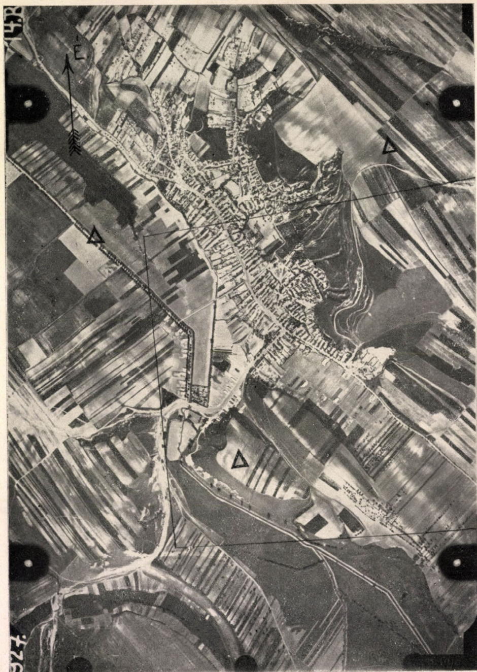
8. kép. A 9. képen látható terület Ny-i részéről készült, a kidolgozásra felhasznált légi fényképlemezpár egyik felvétele. A lemezpár beállításánál használt és a terepen meszelve volt háromszögelési pontok fekete háromszöggel vannak jelölve. Méretarány kb. 1 : 15.000. Repülési magasság kb. 3150 m. A lemez síkjának elhajlása a vízszintestől kb. 15°.
