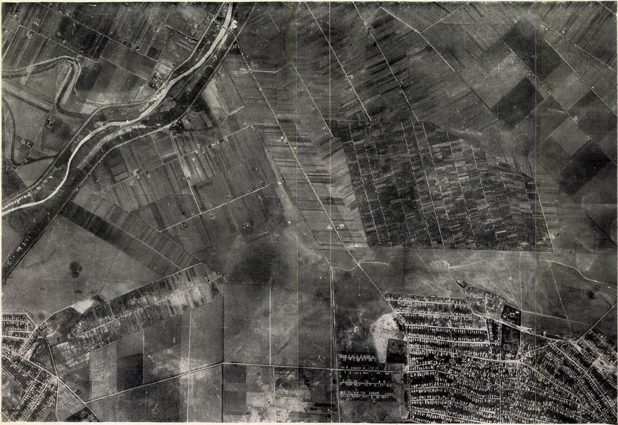
2. kőp. Légi felvételek felhasználásával az Aschenbrenner-féle télautomatikus képtranzformátorral készült fotóterkép 1 : 25.000 méretarányban Mezöbherény környékéről.
