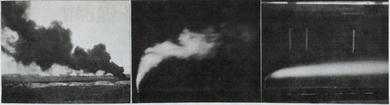
1. kép: Természetben megfigyelt füstfáklya, 2. kép: Füstfáklyáról a szélcsatornában (pillanatfelvétel), 3. kép: A füstfáklya átlagolt oldalnézete
