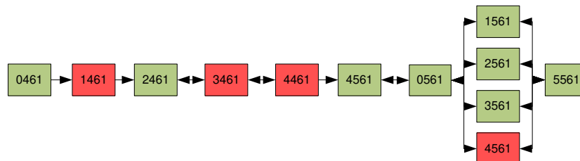
13. ábra: A vizsgált gyártórendszer felépítettsége a karbantartásra beütemezhető berendezésesekkel kiemelve
