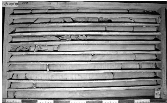
7. ábra. Ép, szinte tagoltságmentes mészmárga (Budai Márga Formáció) a Gellért hegy É-i lábánál lemélyített fúrásban
