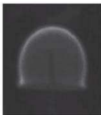
Flamme im schwerelosen Raum (ohne Konvektionsströmung)
