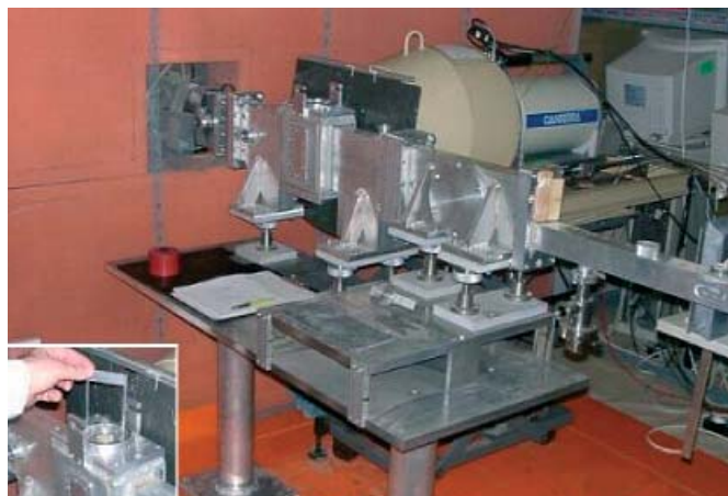
1. ábra. Prompt-gamma aktivációs analízis mérőegységének részlete
