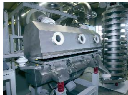
19. ábra. Vibra-Schultheis műanyagpellet-kristályosító
