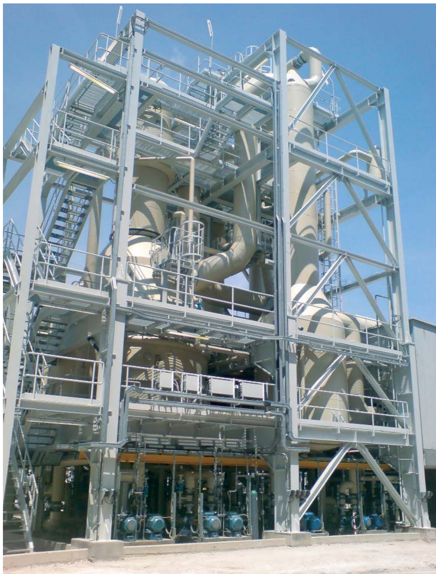
7. ábra. 37 t/h kapacitású NaCl-oldat-besűrítő MVR-üzem
