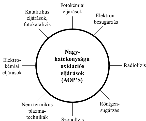
1. ábra. Gyökgenerálásra használatos eljárások [1] (Thomas Oppenländer engedélyével felhasználva és átrajzolva)
