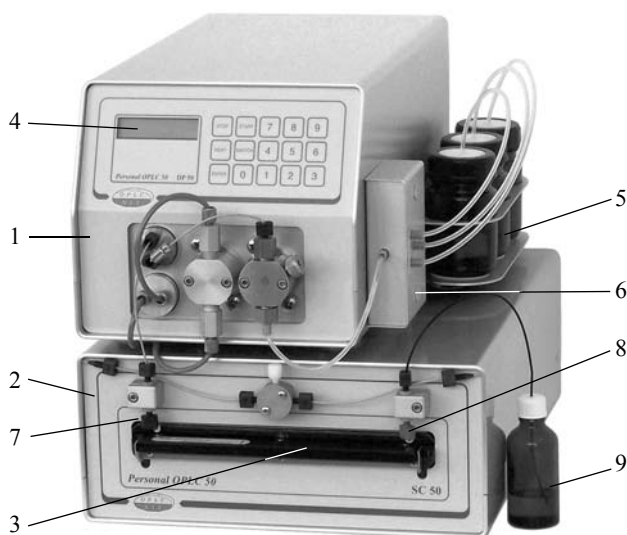
3. ábra. Az automata OPLC 50 rendszer. 1) folyadék szállító egység; 2) elválasztó kamra; 3) kazetta; 4) LCD kijelző; 5) eluens tartályok; 6) eluens-átváltó szelep; 7) eluens bemenet; 8) eluens kimenet; 9) szennyes oldószertartály
