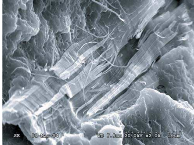
5. Ábra. A nagy szemcseméretű faliszt töltőanyag törése a jellemző mikromechanikai deformációs folyamat.
