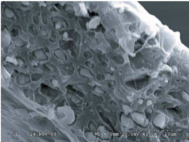
4. Ábra. Lélegző fólia keresztmetszetéről készült SEM felvétel.
