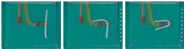
7. Ábra. Anatóz töltőanyagot tartalmazó elasztomer alakváltozása inhomogén, egyenáramú elektromos térben
