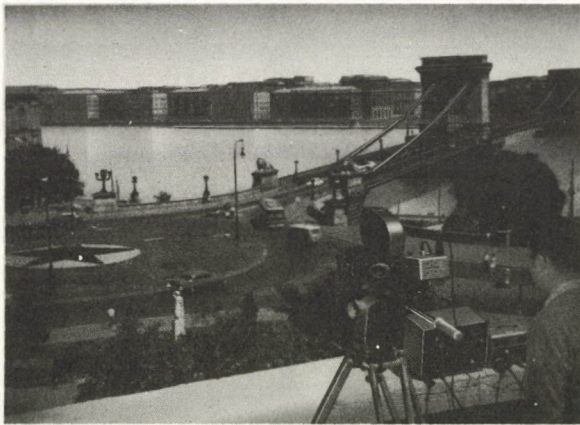
6. ábra. Forgalmatszámolás filmfelvételekről. A budapesti Clark Ádám tér forgalmát különböző időpontokban 2...4 s-ként Arriflex 35 filmfelvételgéppel fényképezik
