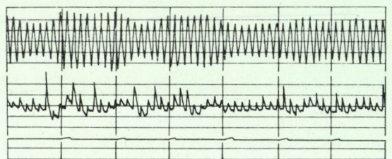
28. ábra. A 15. ábra y irányú elmozdulásához tartozó jelalak 8 Hz-es terc-szűrővel elemezve
