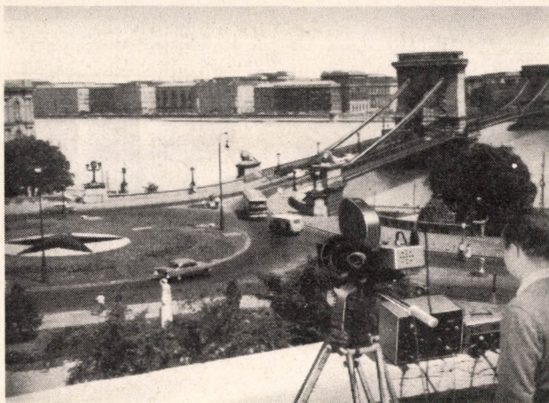
6. ábra. Forgalm számlálás filmfelvételekről. A budapesti Clark Ádám tér forgalmát különböző időpontokban 2...4 s-ként Arriflex 35 filmfelvételével fényképezik
