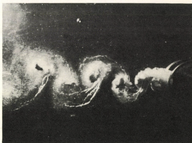
5. ábra. Ek mögötti kavitációs áramlás képe (Az áramlás iránya a testtől a kavitációs zóna irányába)
