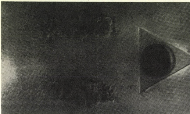
11. ábra. A kavitációs eróziós hatás képe 60°-os ékkavitáció esetében (A kavitációs áramlás iránya a kavitációt keltő testtől a roncsolás irányába)
