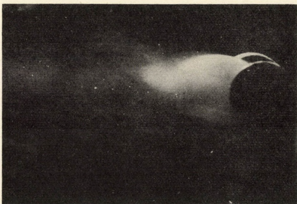
11. ábra. A vizuálisan megfigyelhető — ék-modell mögött kialakult — kavitációs zóna. Az expozíciós idő 1/20 s
