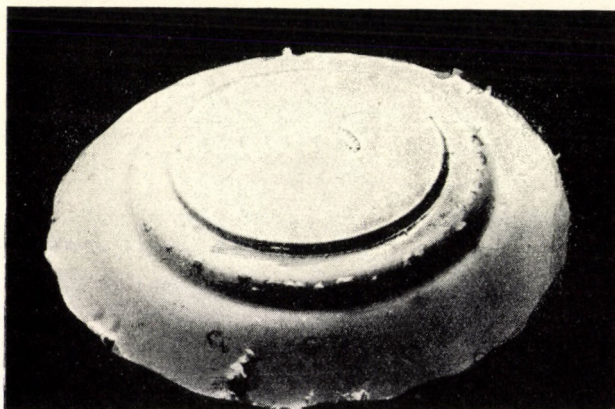
Abb. 2. Unterteil des in Abb. 1 gezeigten Fayencetellers mit einer Reihe kleiner Sprünge.
