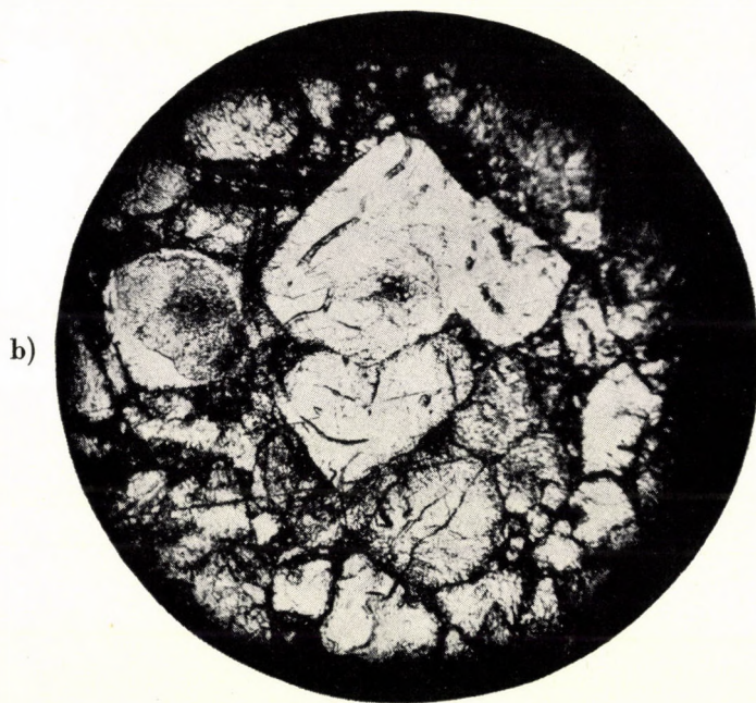
Abb. 4. Polierte und geätzte Pastillenoberflächen.
