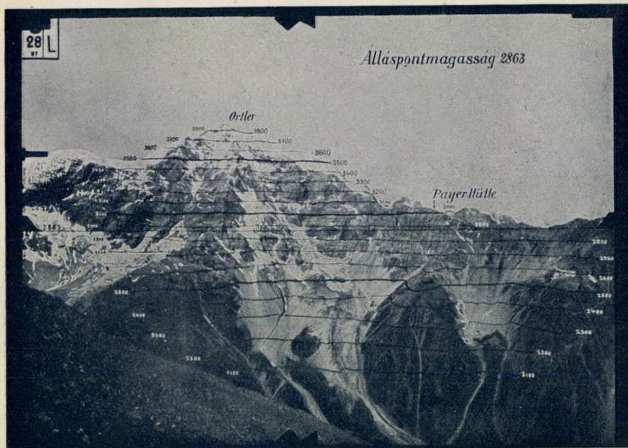
10. kép. Az 1907. évi ORTLER-felvétel 28. sz. álláspontról. Baloldali kép (Suldner-oldalak). Az önműködő rétegfektetési munka első kísérlete. A távlati rétegvonalakat (rétegmagasság 100 m) úgy kapták, hogy a meghatározott, egyenlő magasságú pontokat szabadkézzel összekötötték.
