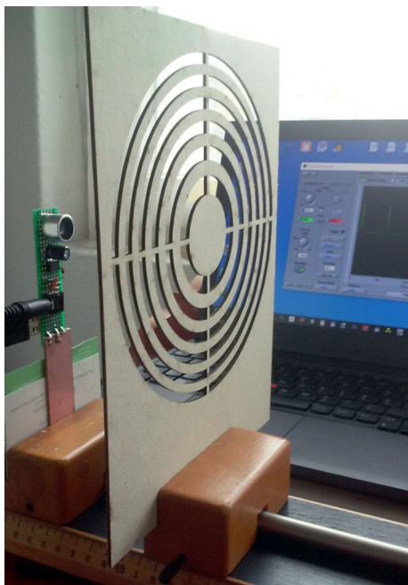
12. ábra. Az elkészült Fresnel-lencse mérés közben.
