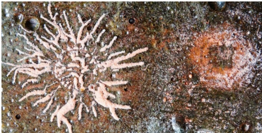
18. ábra. Lichtenberg-ábrák fémtányérra öntött zöldes színű spanyolviaszon, kén- és miniumporral.
