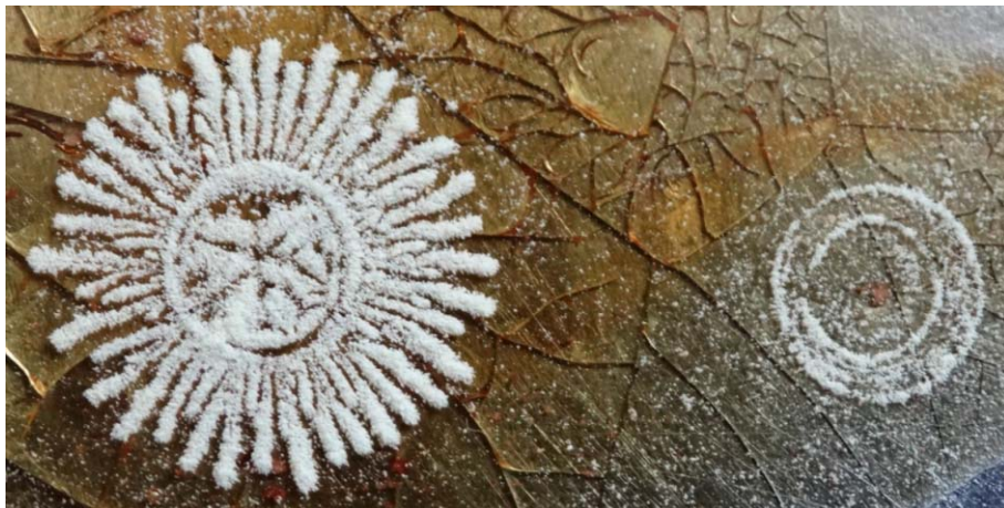
14. ábra. Lichtenberg-ábrák fémtányérra öntött hegedűvonó-gyantán, kénporral.
