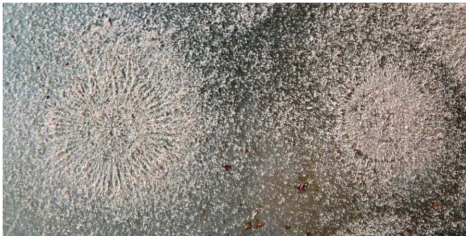
11. ábra. Lichtenberg-ábrák fémtányérra öntött zöldes színű spanyolviaszon, likopódiumporral.
