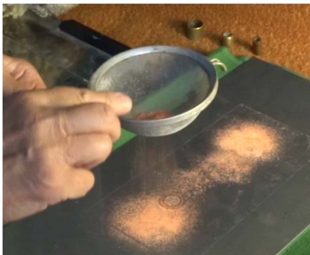
16. ábra. Mínium- és kénpor keverékének szórásakor alakulnak ki a Lichtenberg-ábrák.
