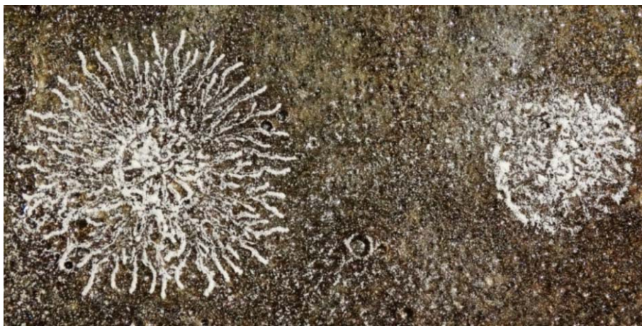
12. ábra. Lichtenberg-ábrák fémtányérra öntött zöldes színű spanyolviaszon, kénporral.
