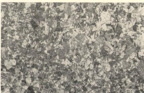
Bild 13. Gefüge der Stauchung bei 700° C (Verformung: 48%, Formänderungsgeschwindigkeit: 620% sec<sup>-1</sup>, Abschreckung in Kochsalzlösung, Vergrößerung: 50×)
