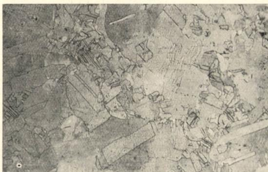
Bild 12. Gefüge der Stauchung bei 700° C (Verformung: 15%, Formänderungsgeschwindigkeit: 620% sec<sup>-1</sup>, Abschreckung in Kochsalzlösung, Vergrößerung: 50×)
