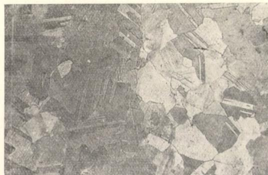
Bild 16. Gefüge der Stauchung bei 900° C (Verformung: 10%, Formänderungsgeschwindigkeit:  $620\% \text{ sec}^{-1}$ , Abschreckung in Kochsalzlösung, Vergrößerung:  $50\times$ )
