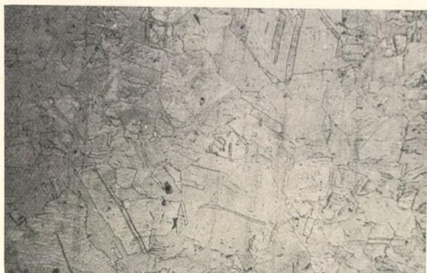
Bild 11. Gefüge der Stauchung bei 500° C (Verformung: 60%, Formänderungsgeschwindigkeit: 746% sec<sup>-1</sup>, Abkühlung in Luft, Vergrößerung: 50×)
