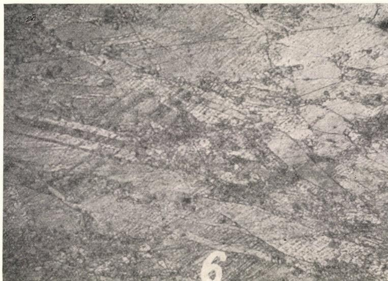
Bild 10. Gefüge der Stauchung bei  $500^{\circ}\text{C}$  (Verformung: 60%, Formänderungsgeschwindigkeit:  $16200\text{ sec}^{-1}$ , Abschreckung in Kochsalzlösung, Vergrößerung  $100\times$ )
