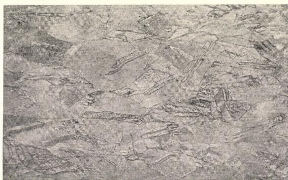
Bild 9. Gefüge der Stauchung bei  $500^{\circ}\text{C}$  (Verformung: 48%, Formänderungsgeschwindigkeit:  $620\text{ sec}^{-1}$ , Abschreckung in Kochsalzlösung, Vergrößerung: 50%)
