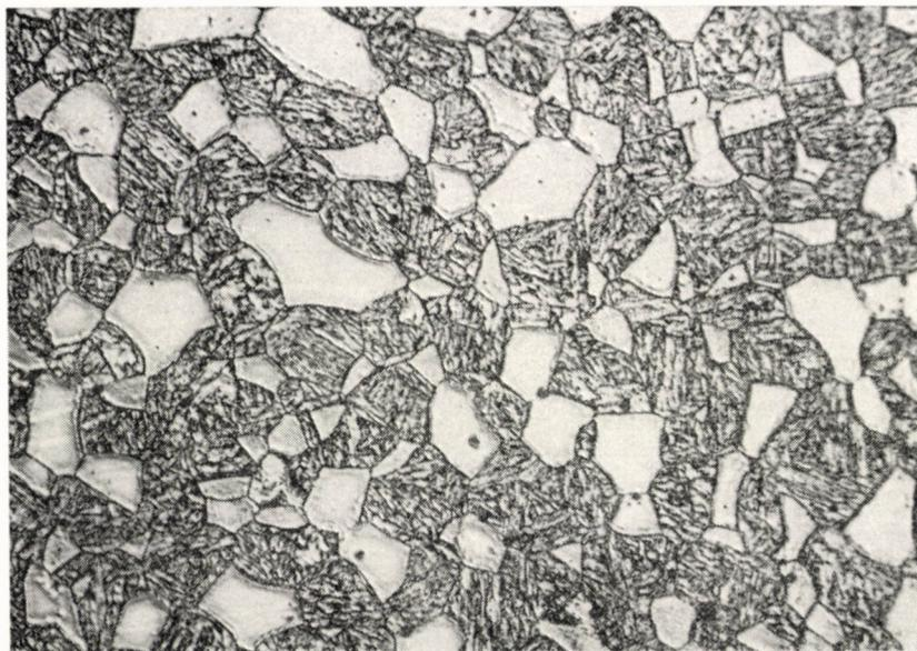
Рис. 7. Микроструктура 12% Cr стали (89)
