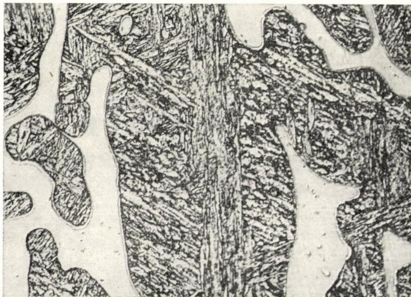
Рис. 8. Микроструктура 12% Cr литой стали (63)
