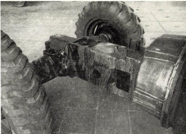
*Bild 20.* Dehnlinien auf dem Graugußbrumpf eines Schleppers bei einseitig an einem Rad in Fahrtrichtung angreifender Kraft. Da Grauguß dem Hookeschen Gesetz nicht gehorcht, kann man nicht aus den gemessenen Dehnungen die Spannungen berechnen, aber man kann schon aus dem Dehnliniensfeld wichtige Schlüsse ziehen. Hier zeigten sich die Kanten des rechteckigen Ausschnittes als gefährdet, auch die kleinen Schraubenlöcher und die Ausbuchtungen
