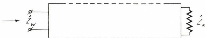
Bild 5. Die elektrische Ersatzschaltung der Höhle im Bereich der hohen Frequenzen
