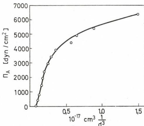
Abb. 11. Änderung der Gleichgewichtsdicke ( $1/d^3$ ) mit dem angelegten Druck
