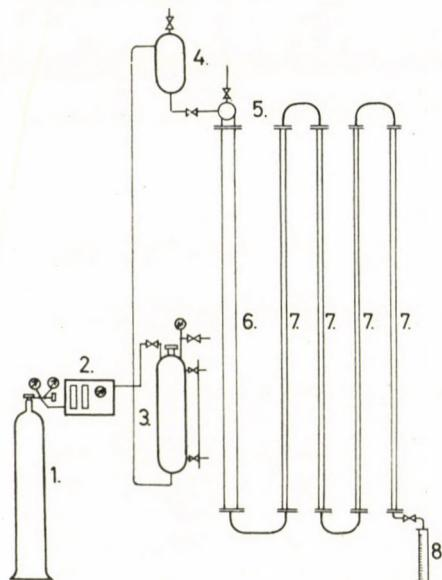
Abb. 5. Einrichtung zur Chromatographie von Bitumina. 1 — Stickstoff-Flasche; 2 — Druckregler; 3 — Lösungsmittelbehälter; 4 — Zwischengeschaltetes Gefäß; 5 — Schauglas; 6 — Säule mit 80 mm Durchmesser; 7 — Säule mit 40 mm Durchmesser; 8 — Sammelgefäß
