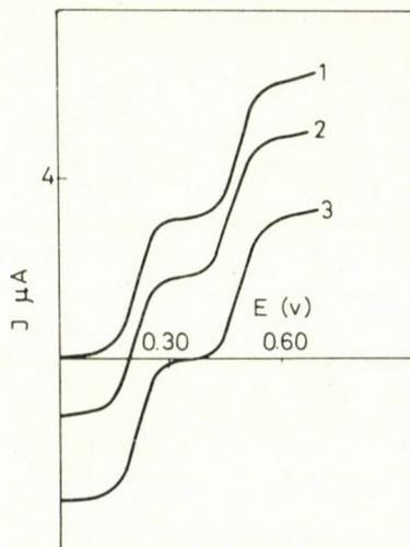
Fig. 1. Modification de la courbe intensité-potential au cours de l'oxydation à potentiel contrôlé sur la première vague. Concentration en Persantine:  $4.10^{-4} M$ ; Courbe 1: Persantine seule en solution; Courbe 2:  $1/2$  (env.) de la Persantine est oxydée en  $R^{+}$ ; Courbe 3: Toute la Persantine est oxydée en  $R^{+}$ .
