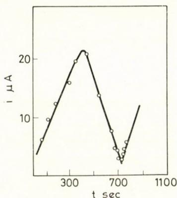
Fig. 4. Titrage coulométrique de la Persantine à intensité constante. Détermination du point équivalent par ampérométrie avec deux électrodes indicatrices.  $E_a - E_c = 50$  mV. Concentration en  $P$ :  $5,7 \cdot 10^{-4}$  M (11,40 mg  $P/40$  ml  $CH_3CN$ ). Intensité: 3,00 mA; Durée de l'électrolyse: temps calculé: 726,60 sec., temps mesuré: 720,12 sec
