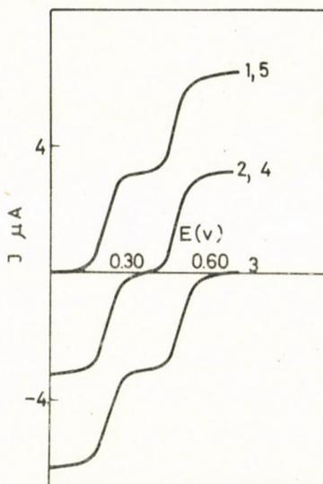
Fig. 2. Modification des courbes voltampérométriques au cours de l'oxydation à potentiel contrôlé sur la deuxième vague. Courbe 1:  $P$  seul en solution; Courbe 2:  $P$  est entièrement oxydée en  $R^{\cdot+}$ ; Courbe 3:  $Q^{++}$  seul en solution; Courbe 4: Réduction complète de  $Q^{++}$  en  $R^{\cdot+}$  (à + 0,300 Volt); Courbe 5:  $R^{\cdot+}$  est réduit en  $P$  (à 0,00 Volt)
