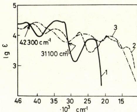
Fig. 6. Déformation du spectre d'absorption ultraviolet et visible d'une solution de la Persantine  $3,1 \cdot 10^{-4} M$  dans l'acétonitrile  $0,1 M$  en  $\text{LiClO}_4$  au cours de l'oxydation à  $+0,300$ , puis à  $+0,600 V$ . Courbe 1: Persantine ( $P$ ) seule en solution; Courbe 2: Radical ( $R^+$ ) seul en solution; Courbe 3: Cation divalent ( $Q^{++}$ ) seul en solution
