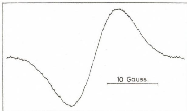
Fig. 5. Dérivée du spectre expérimental de R. P. E. du radical cation obtenu par oxydation électrochimique de la Persantine au sein de l'acétonitrile
