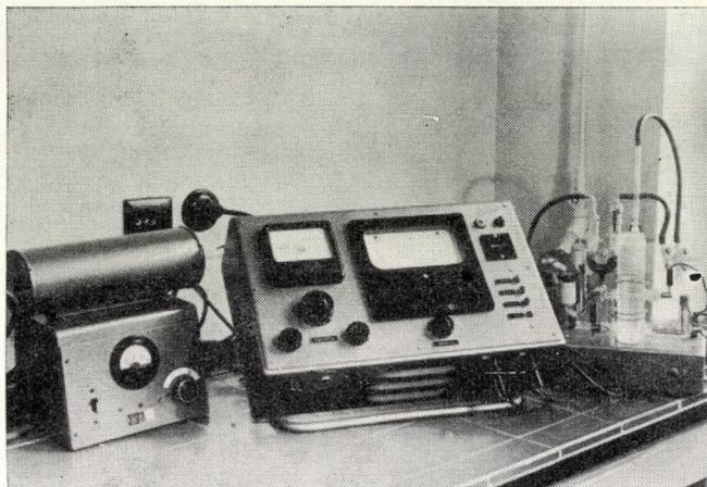
Abb. 5. Kohlenstoffbestimmungsapparat nach OELSEN—ABRESCH
