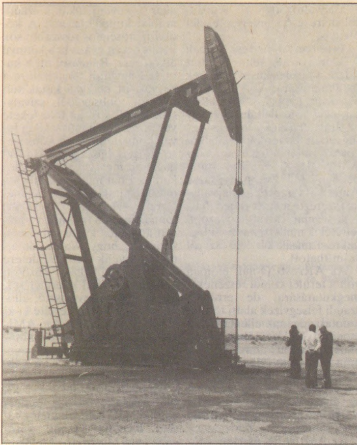
A Föld legnagyobb kőolaj-mélyszivattyúja Wafra-kőolajmezőben. Naponta 500 m 3 kőolajat szív fel
