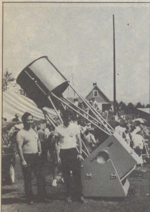
John Vogt 75 cm tükörátmérőjű Dobson-távcsöve az 51. Stellafane Találkozón (Springfield, USA). A teleszkóp előtt balra John Bortle, az AAVSO Circular szerkesztője, jobbra a távcső építője látható
