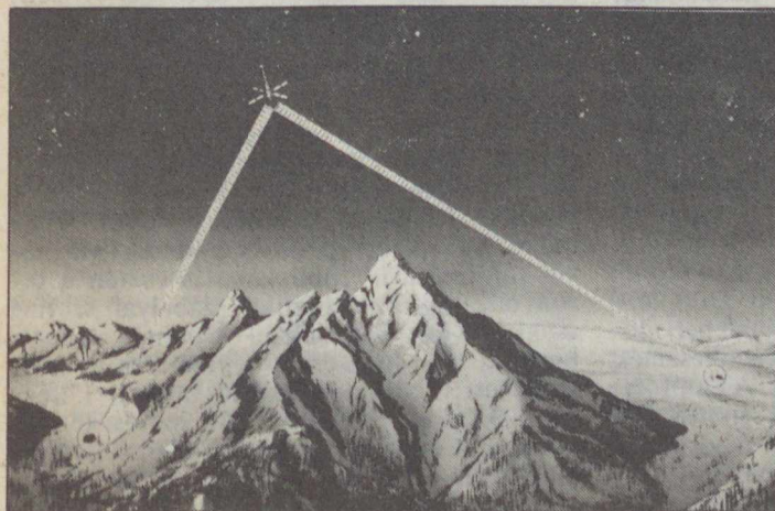
4. ábra. Két vevőkészülék egyidejű működtetése transzlokációban. A tereppontok között a hegység miatt nincs összelátás. A hagyományos geodéziai mérés ilyen esetben körülményes
