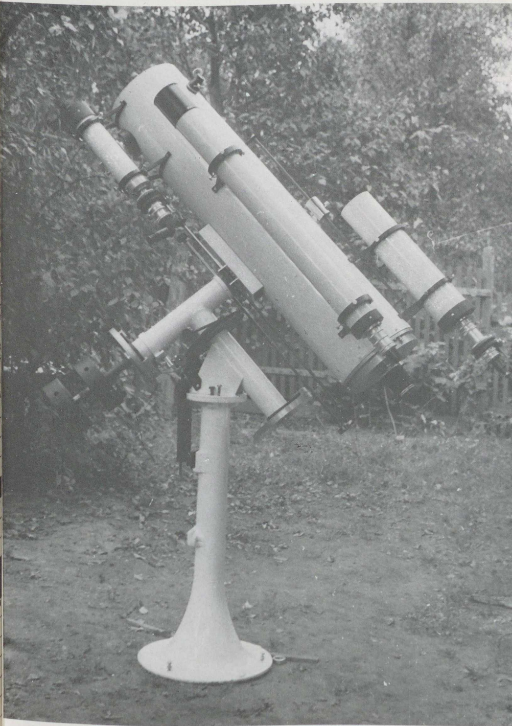
Farkas László budapesti amatőr távcsöve. A főműszer tükrőátmérője 260 mm. A vezető távcső 80/1200-as refraktor. A kereső objektíve 72/500-as akromát. A közös tengelyre szerelt üstökös-kereső 100/600-as reflektor.
