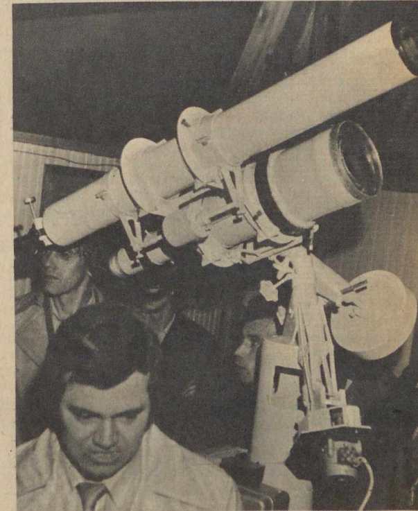
A 80/1000-es és a 160/800-as refraktor (A felvételeket Csik Ferenc készítette)
