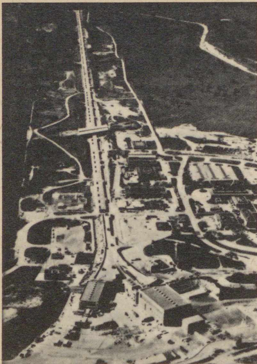
A laboratóriumban elérhető részecskeenergiák még messze elmaradnak a galaktikus kozmikus sugárzás energiájától. Képiünk a California állambeli stanfordi lineáris gyorsítót mutatja, amellyel 2 \cdot 10^{13} eV energiát lehet elérni. Ez még mindig ezerszer-milliószor kisebb, mint a legnagyobb kozmikus részecskeenergia
