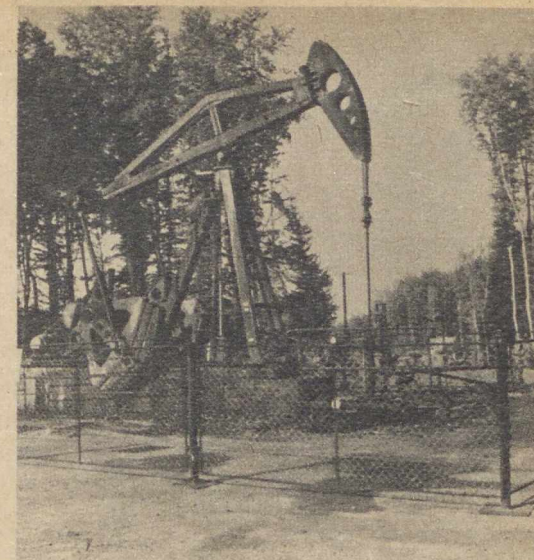
A kőolaj és földgáz korunk nélkülözhetetlen energiaforrása. A dunántúli táj valóságos szimbólumának tekinthetők az olajat felszínre hozó mélyszivattyúk, az ún. himbák. (Juhász Árpád felvételei)
