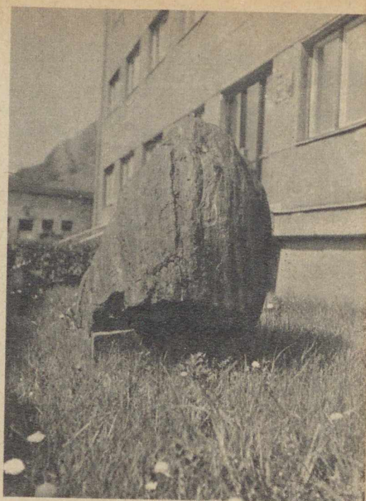
Hazánk viszonylag igen gazdag mangánércben. Legnagyobb bányáink a Bakonyban vannak, Urkúton és Eplényben. A mangánérc nagyobb része a nehezen kohósítható karbonátos ásvány formájában található. A képen a ritkább és részben már lebányászott oxidos mangánérc egyik változata figyelhető meg. E hatalmas, soktonnás „babszem” jelenleg az úrkuti bányaépület előtt áll
