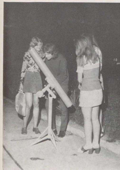
A Csillagászat Baráti Köre 7000. tagja László Ferenc géplakatos (4461 Nyírtelek, Jókai u. 36) ezt a 80/1000-es Newton reflektort kapta ajándékba. A műszert az Uránia dolgozói társadalmi munkában készítették
