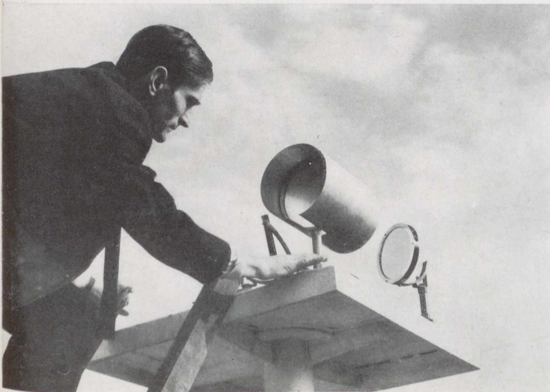
A napmegfigyelő műszer cölösztátjának beállítása. A gyűjtőlencse 12 méter gyűjtőtávolságú és 200 mm átmérőjű. A képen Kancsura Árpád látjuk. (Fotó: Dr. Dankó)
