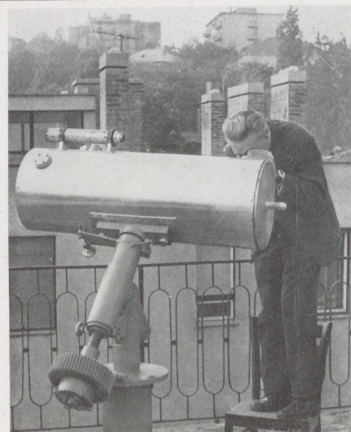
A budapesti Uránia új, 300/1080 reflektora. A műszer használható Newton-rendszerben és a segédoptika 180 fokok átfordításával mint 300/3500-as Nasmyth reflektor
