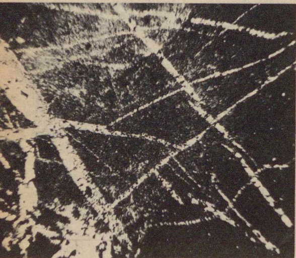
Csak mikroszkópon látható repedések hálózata kőzet vékonycsiszolatában
