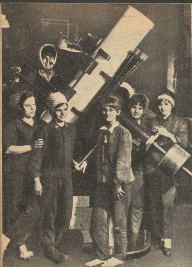
A dunaújvárosi távcsőépítő ipari tanulók egyik csoportja. A Newton-szerelésű távcső átmérője 30 cm
