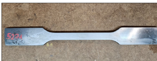
Fig. 6. The tensile test specimen.
