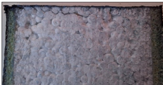
5. ábra. A tönkremenetel utáni keresztmetszet képe
