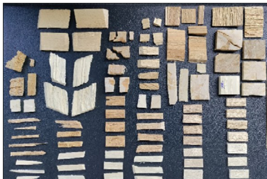
2. ábra. A próbatestekről levágott próbatestek, amelyek a törésfelületek vizsgálatára szolgálnak
