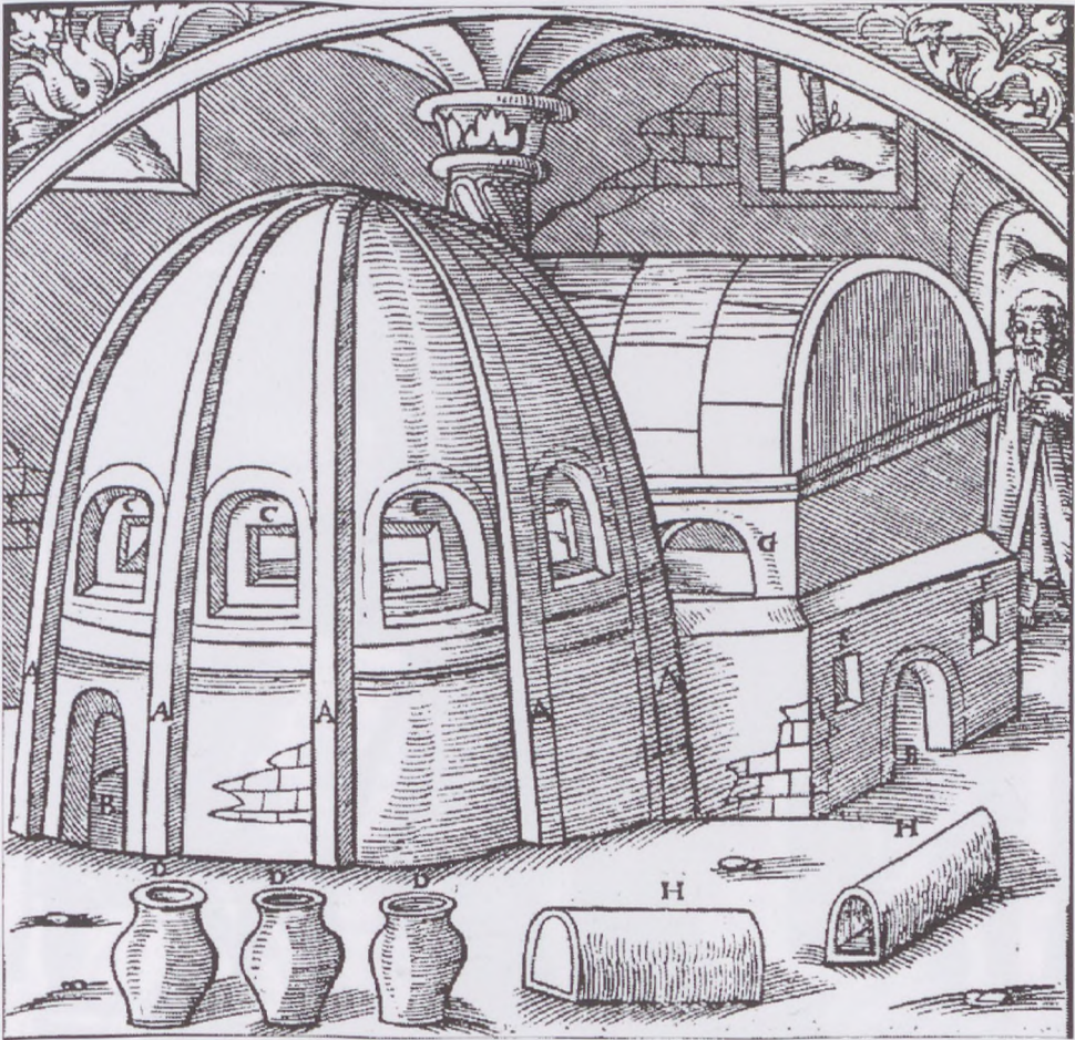
7. ábra. Üveg- és hűtökemence. AGRICOLA é.n. 575. A: A kemence bordaboltozata, B: alsó kamra szája, C: felső kamra ablaka, D: olvasztótégely, E: harmadik kemence szája, F: edények tartóhelye, G: felső kamra nyílásai, H: hosszúkás edény. (Tárgymagyarázat: STIAFFINI 1999, 58.)
