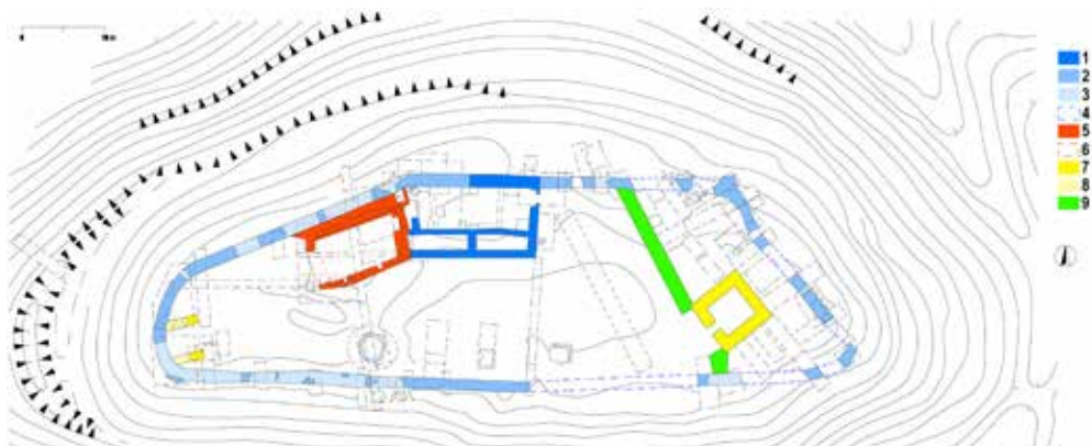
5. kép A vár alaprajza a kutatóárkok és az építési periódusok feltüntetésével: 1–4.: 14. század vége, felmenő fal, alapozás, alapozási árok; 5–6.: 15. század közepe, a mélypince álló és kidőlt falai; 7–8.: 1500 körül, felmenő és alapfal, alapozási árok; 16. század első fele. (készítette: Feld István)
