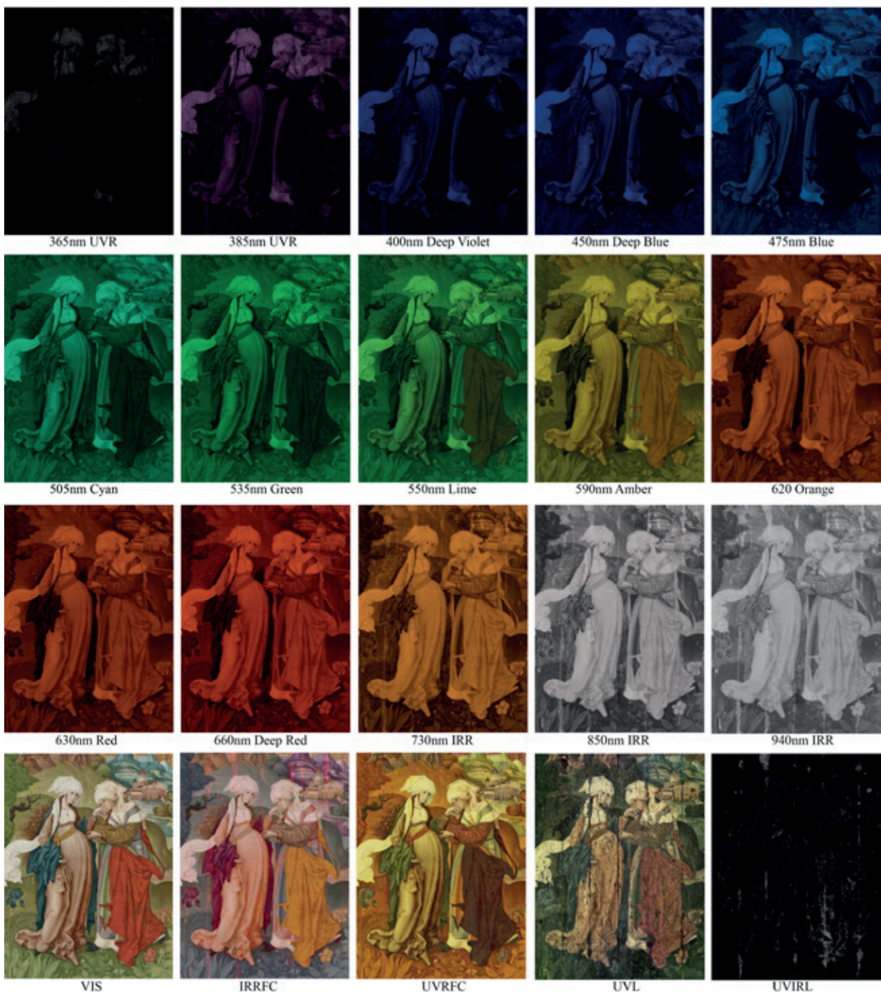
1. kép MS Mester Vizitációról készült keskeny sávú (Narrowband) felvélsorozat, az ultraibolya tartománytól (365 nm) az infravörös (950 nm) terjedő sávokban. Multiband széles sávú, multispektrális (Multiband) felvélsorozat, 3 reflexió (VIS, UVR, IRR), 2 db lumineszcens (UVR, IRL, UVIRL) és 2 kevert csatornás kép (IRRFC, UVRFC), 2023. (Készítette: Horváth Mátyás – Phase One Rainbow Multispectral Imaging)
