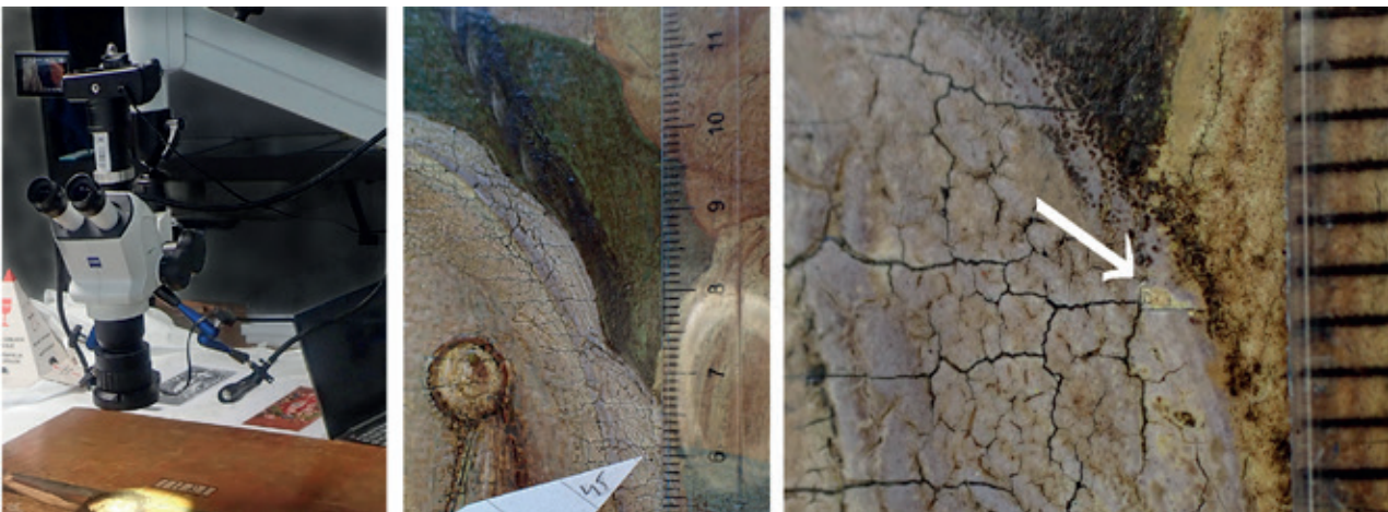
2. kép a.) ún. operációs mikroszkóp, ami egy mozgatható állványon lévő sztereo- mikroszkóp. b.), c.) Egy kivett minta helye a repedésháló mentén. Minta mérete mm alatti, erősebb nagyítás nélkül nem is észlelhető a hiány, 2023. (Fotó: Galambos Éva)
