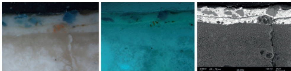
5. kép h., i.) Keresztmetszet csiszolat részlete normál fényben és lumineszcens felvételen (BV-LU) j.) a visszaszórt elektron kép (SEM_BSE) az alapozóban egy biogén töredék jól látszik a repedés mellett
