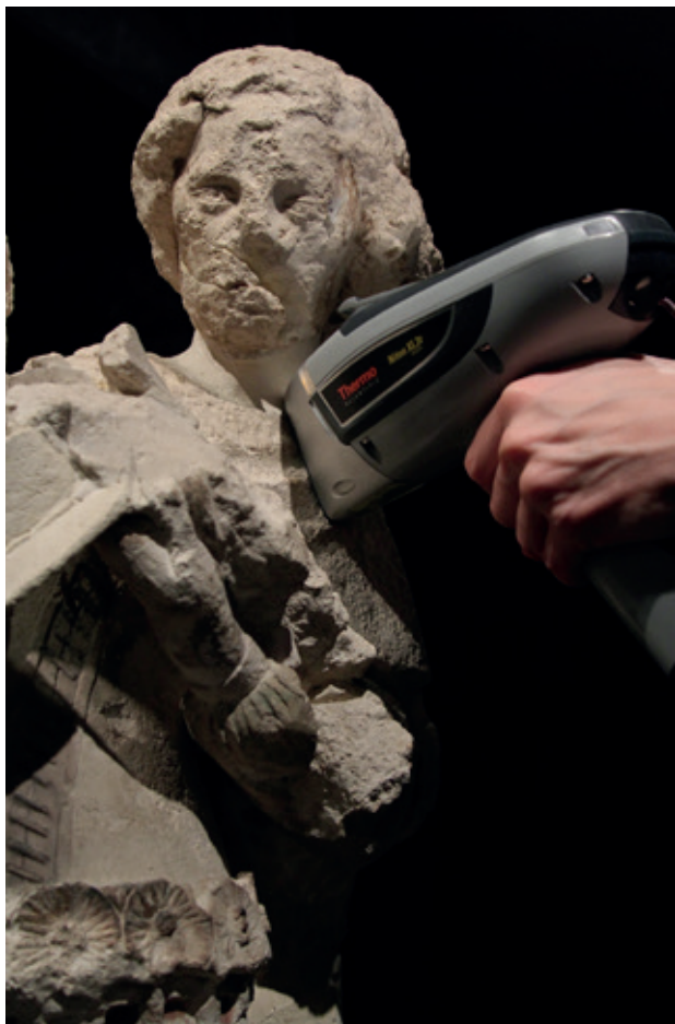
3. kép Kézi XRF berendezés a Budavári szoborlelet mérése közben, a műszer feje nem fér be a kisebb plasztikai mélyedésekbe, 2023. (XRF: May Zoltán)
