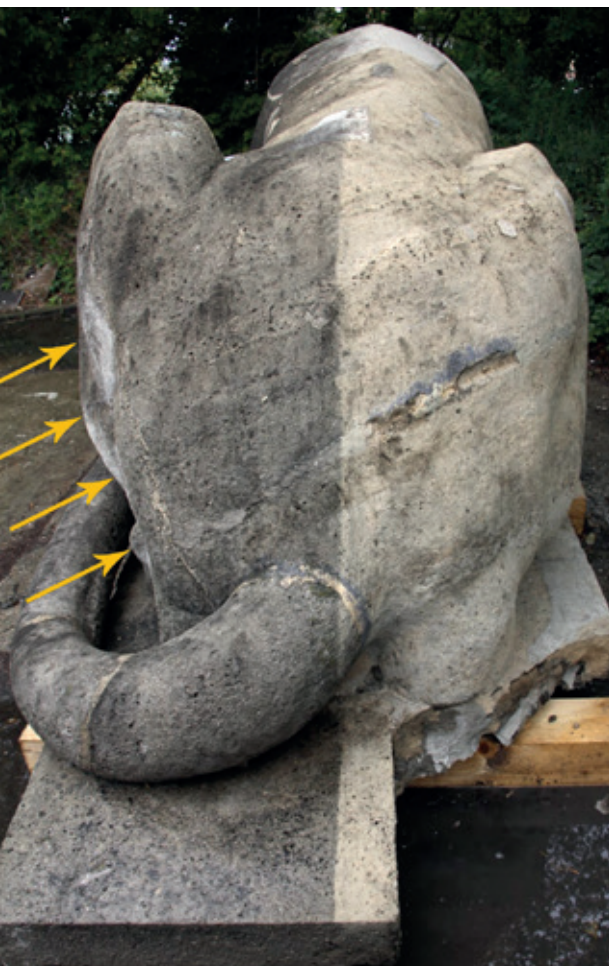
10. kép A magasnyomású vízsugárral félbetisztított pesti-déli oroszlán hátsó darabja. Az elemen látható a plintosz világháborús sérülése és a több darabból összeillesztett farok. A sárga nyilak a mészkő üledékréteg-határainak irányát mutatják. A magasabb tömbök esetében ez az irányultság közel függőleges. (Fotó: Szemerey-Kiss Balázs)
