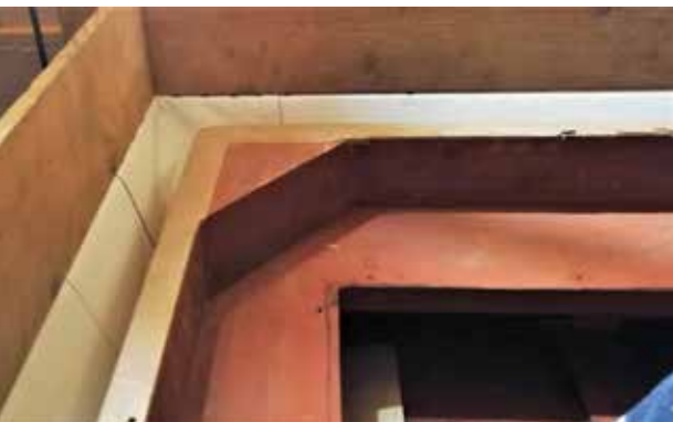
15. kép Mindhárom ládafúvó bőrözését az eredetivel megegyező anyaghasználat és technológia szerint cseréltük
