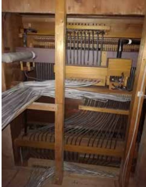
13. kép A kis, egymanuális játszóasztal restaurált pneumatikája
