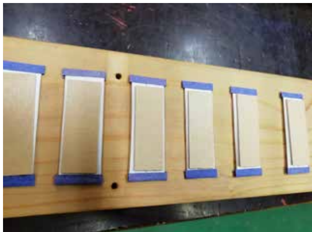
11. kép Új membránok, az eredetivel megegyező anyaghasználat és méretezés szerint
