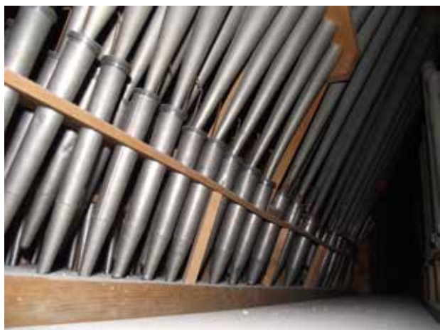
9. kép Több sípakasztó kilazult, emiatt a sípok kidőltek a helyükről. (A képen a III. manuál Angolkürt 8' regisztere látható.)
