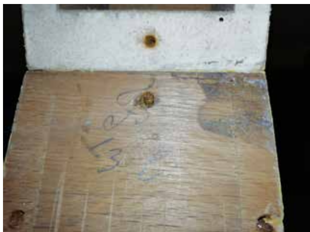
17. kép A forslag belsején kézírás jelöli, a síp eredetileg melyik regiszter milyen hangját adta a Hesse-orgonában. (Alul a Rieger-féle átintonálás nyomai láthatók.)
