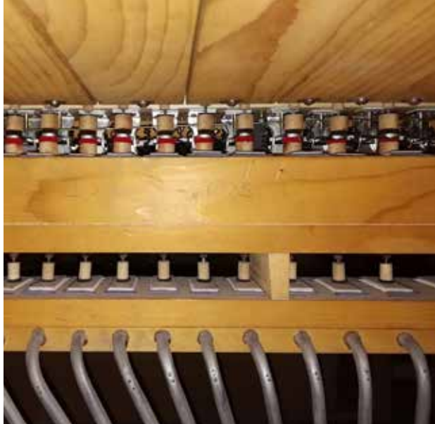
14. kép Az I. manuál szelláda felújított vezérlése – a szelláda elektromosan és pneumatikusan egyaránt működtethető
