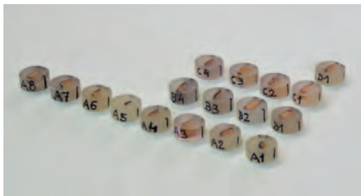
20. kép Műgyantába ágyazott keresztmetszeti festékminták, a műgyanta ágyazás átmérője 11 mm
