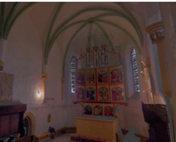
15. kép A lézerszkennelt pontfelhő különböző adatok alapján színezett képe: fotózás révén rögzített RGB színinformáció, a pontok intenzitásértéke és a pontok normálértéke alapján. Készítette: Krähling János és Fehér Krisztina
