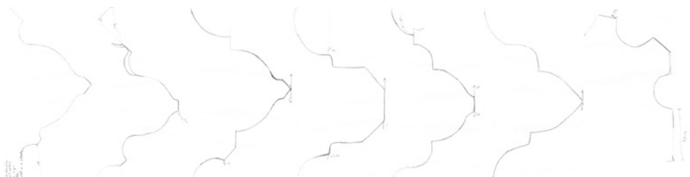
3. kép A nyugati kapubéllet tagozatainak lenyomatai profilfésűs mintavétel alapján. Készítették: Takács Imre vezetésével az ELTE BTK, a KRE BTK, a PPKE BTK, valamint a BBTE-Kolozsvár hallgatói
