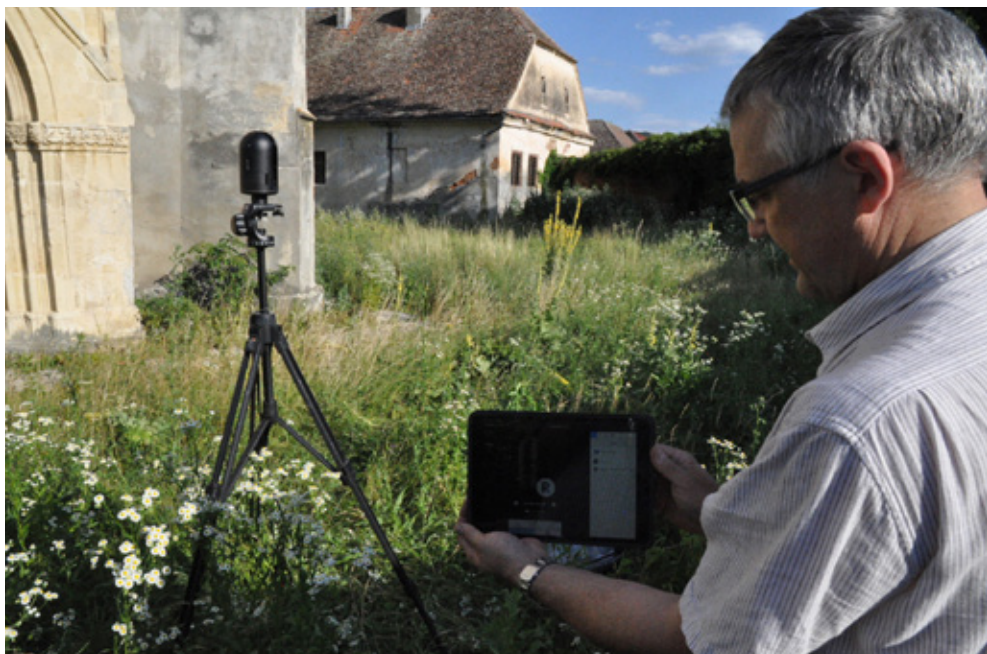
11. kép 3D adatleképezés lézerszkenneléssel.
