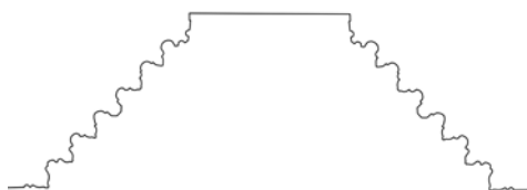
4. kép A nyugati kapu bélletének profilja felszerkesztve. Készítette: Zslebits Judit
