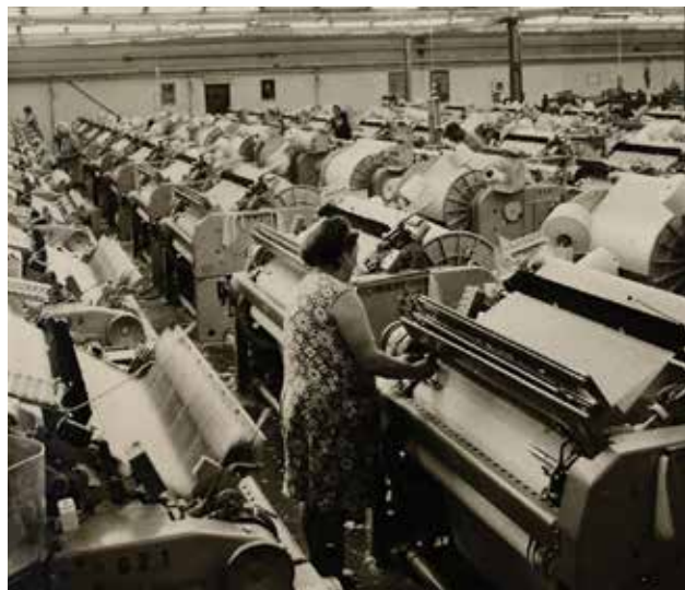
A Lakástextil Vállalat szövőcsarnoka 1975-ben, új P-105-ös cseh szövőgépekkel | Weaving workshop of the Home Textiles Company in 1975 with new Czech P 105 machines
