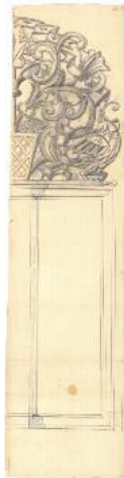
Kozma Lajos: Műhelyrajz beépített vitrinhez (a verzón felirat: Görög leány beépített vitrine) / Lajos Kozma: Shop drawing for a built-in display case (inscription on the verso: 'Built-in display case of a Greek girl') papír, ceruza, színes ceruza, 89x53,5 cm (MMA – Magyar Építészeti Múzeum és Műemlékvédelmi Dokumentációs Központ, Budapest)
