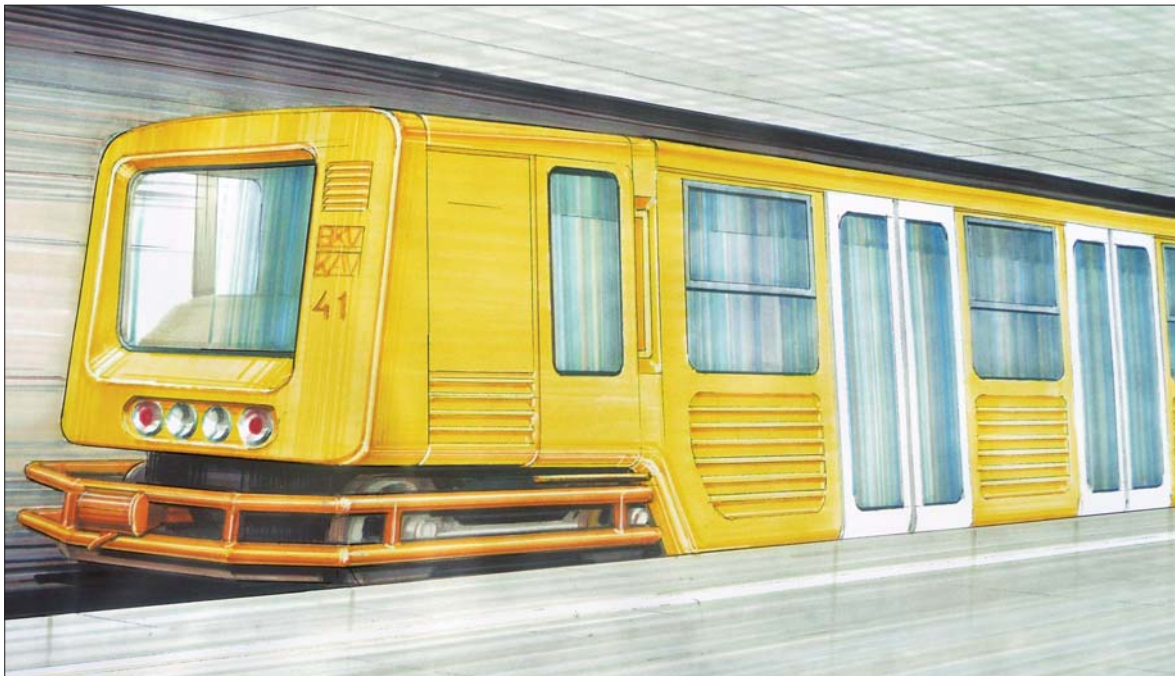
Szentpéteri Tibor: Millenniumi Földalatti Vasút, aszimmetrikus homlokablak-kialakítású szerelvény, előterv-vázlat / Tibor Szentpéteri: Train with asymmetrical windscreens. Millennium Underground Railway. Preliminary design draft [1966] megrendelő: Ganz-MÁVAG / Client: Ganz-MÁVAG
