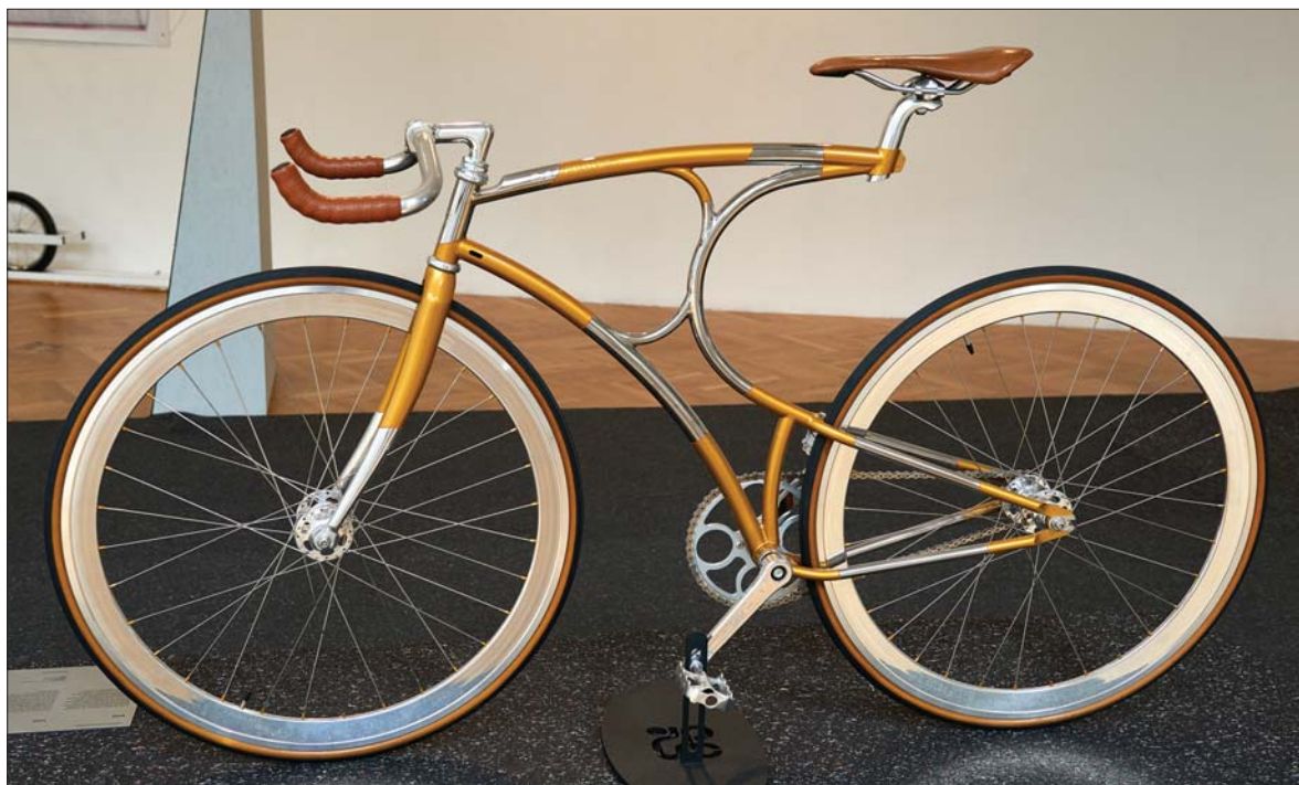
Herman van Hulsteijn – Vanhulsteijn Bicycles: Vanhulsteijn 1 (VH1) kerékpár / Herman van Hulsteijn – Vanhulsteijn Bicycles: 'Vanhulsteijn 1' (VH1) bike [2009] rozsdamentes acél / stainless steel [95x160x42 cm, 10 kg]
