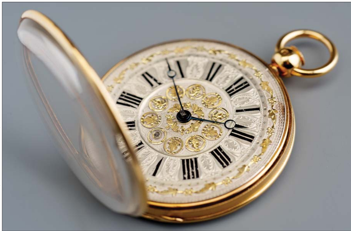
Zsebóra (kulcsos) ütőszerkezettel / (Key) pocket watch with striker mechanism Párizs, 1826, jelzés: Breguet, aranytok, Breguet-henger- gátszerkezet kompenzációs billegőszabályozóval (Radvánszky Ferenc gyűjteménye) / Paris, 1826, sign: Breguet, gold case, Breguet cylinder escape with compensational balance (Ferenc Radvánszky's collection)
