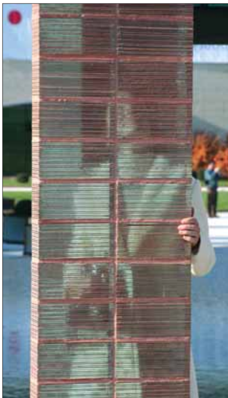
Fekete Zsuzsanna: Zebralit típusú üvegbeton (szabadalom) / Zsuzsanna Fekete: 'Zebralit'-type glass concrete (patent)
