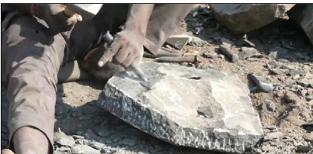
Fig. 24-25. Mühlsteinfabrikat-Fragment in Markaz-Radbauertal, (TZH) Indischer Reibsteinhauer bei der Arbeit mit Hammer und Spitzmeißel https://www.youtube.com/watch?v=_z7TchLLXww
