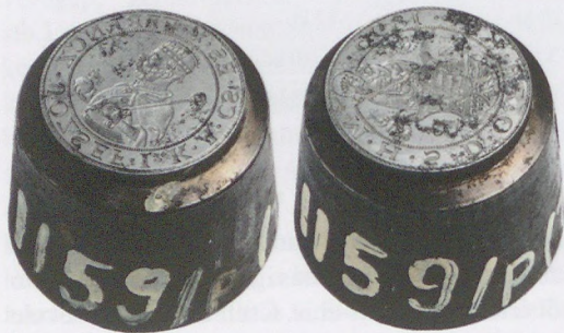
12. ábra. A 16. századi tallér gépi verőszerszámjai (MNB TV ltsz.: VT 51063, VT 52063-1896-KB)
