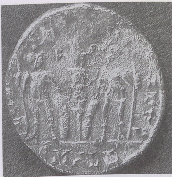
3. kép 2. BRBAJ94b 10× Hátlap, a szélek közelében apró, sugárirányú repedésekkel
