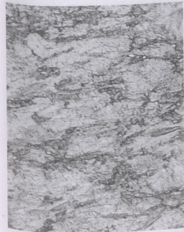
2. kép 3. BRBAJ94f 400× Érme hűrirányú metszete, részlet, a belső részekben is jól megfigyelhető az élek irányába elnyújtott szövetszerkezet
